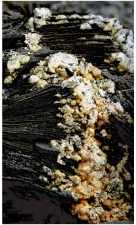
Pickeringit im Dachschiefertagebau „Bärenstein“, gut erkennbar, wie durch das Kristallwachstum die Schieferung aufgespalten wird (Bildhöhe ca. 20 m)/22/
